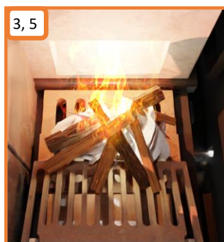
Zátop v kotli
